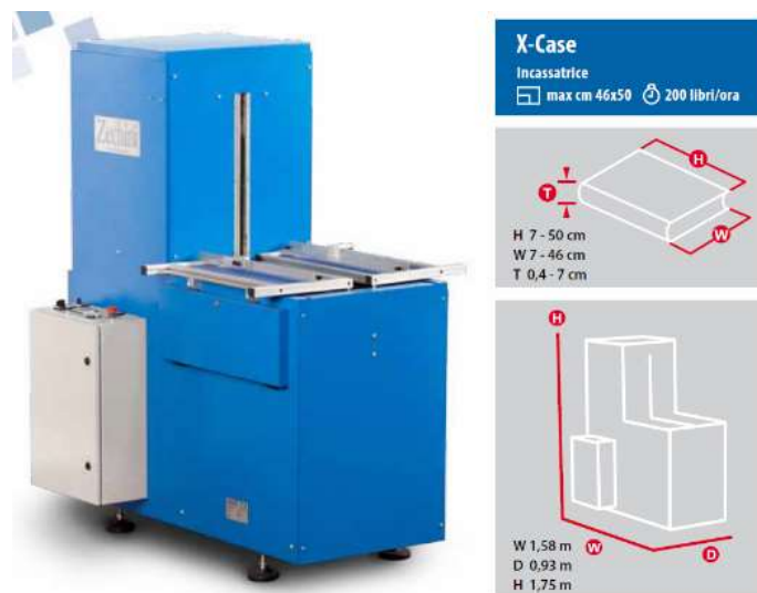
Figura 1.1 - La macchina in esame e alcune sue caratteristiche tecniche rilevanti, che devono essere soddisfatte anche a seguito del revamping.
